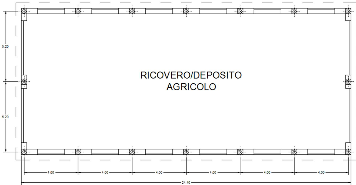
Figura 25: Pianta edificio ricovero mezzi agricoli
