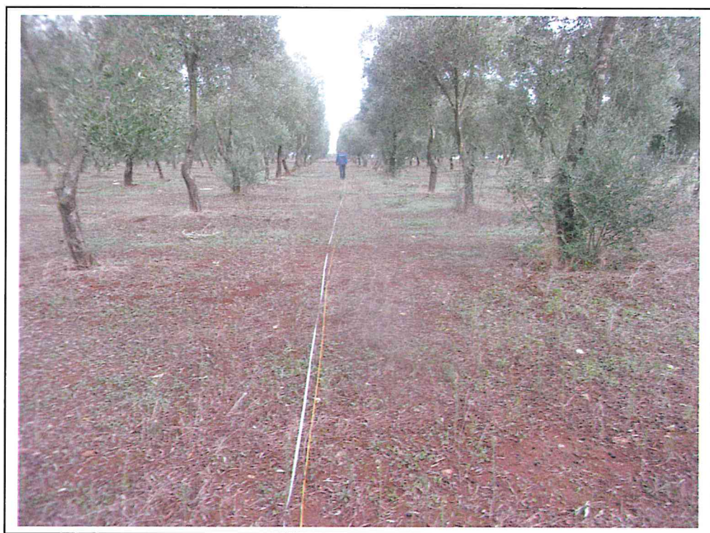
Esecuzione profilo sismico a rifrazione n. 4
