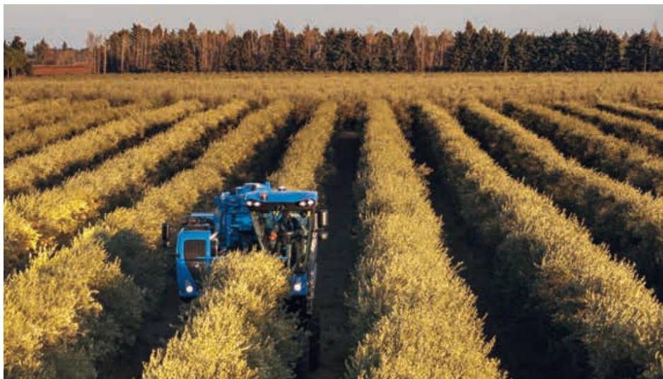
Figura 17 Raccolta meccanizzata con scavallatrice (Fonte: www.newholland.com )
