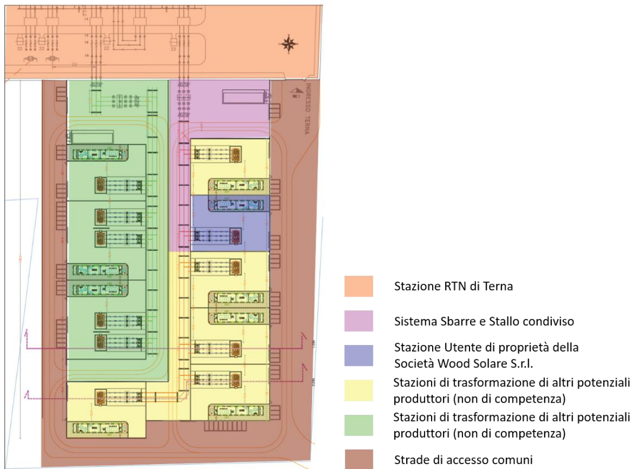
Figura 19 Area dell'Impianto di Utenza: Stazione Utente (in viola), il Sistema Sbarre e lo Stallo Condiviso (in rosa)
