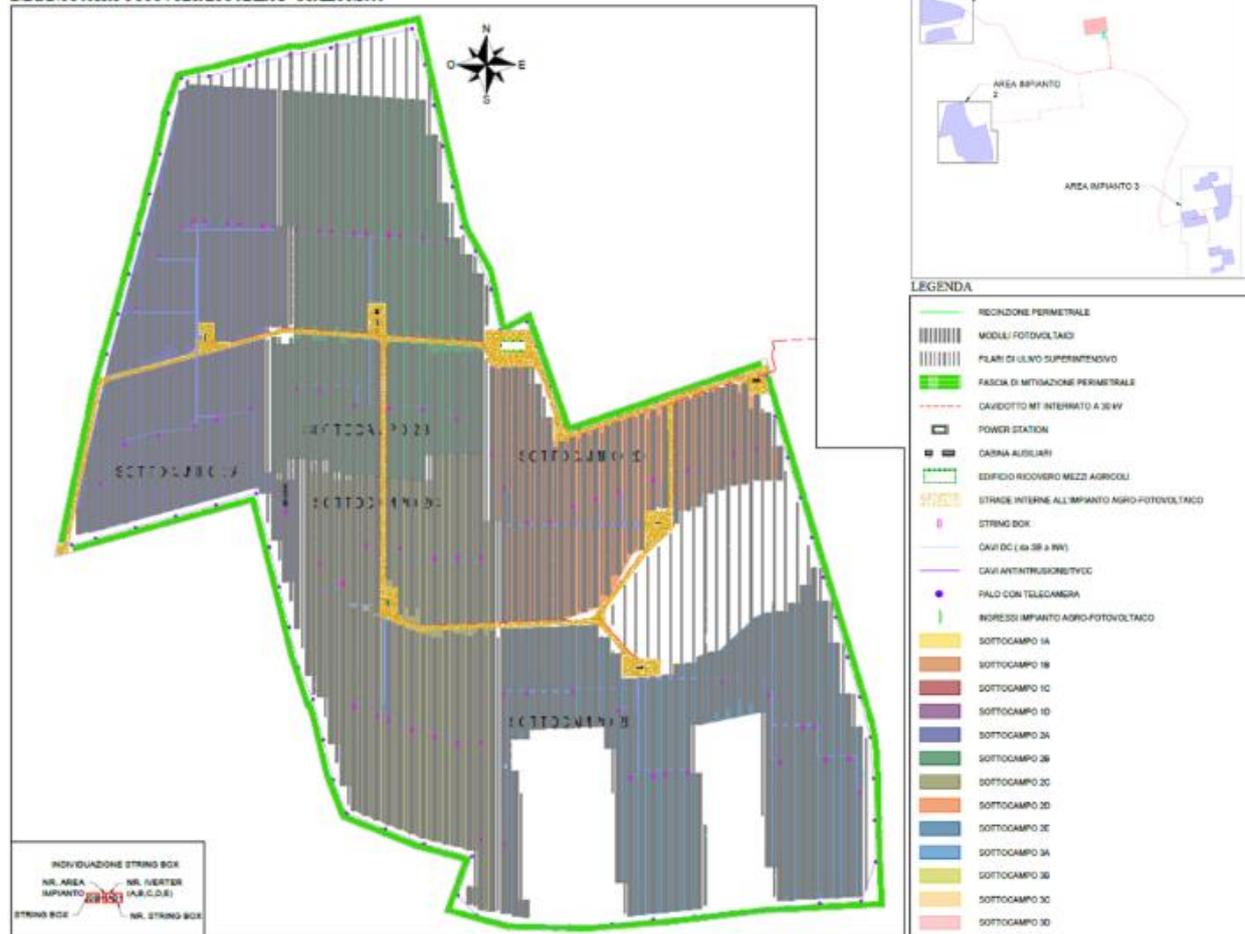
Figura 19 Layout Impianto agro - fotovoltaico con identificazione sottocampi ed opere elettriche – Area 2
