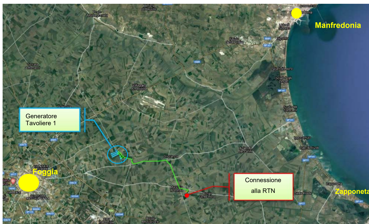
Fig. 3. Inquadramento di ampio raggio su ortofoto dell'area di intervento, situata all'incirca a circa 10km ad Est di Foggia, a Nord, in celeste, la centrale fotovoltaica; in verde, il percorso dell'elettrodotto dorsale, che si sviluppa per circa 11km prevalentemente lungo rete viaria esistente; a SUD la Sottostazione Produttore, nei pressi della esistente Stazione elettrica di Trasformazione SET-TERNA 380/150kV.
