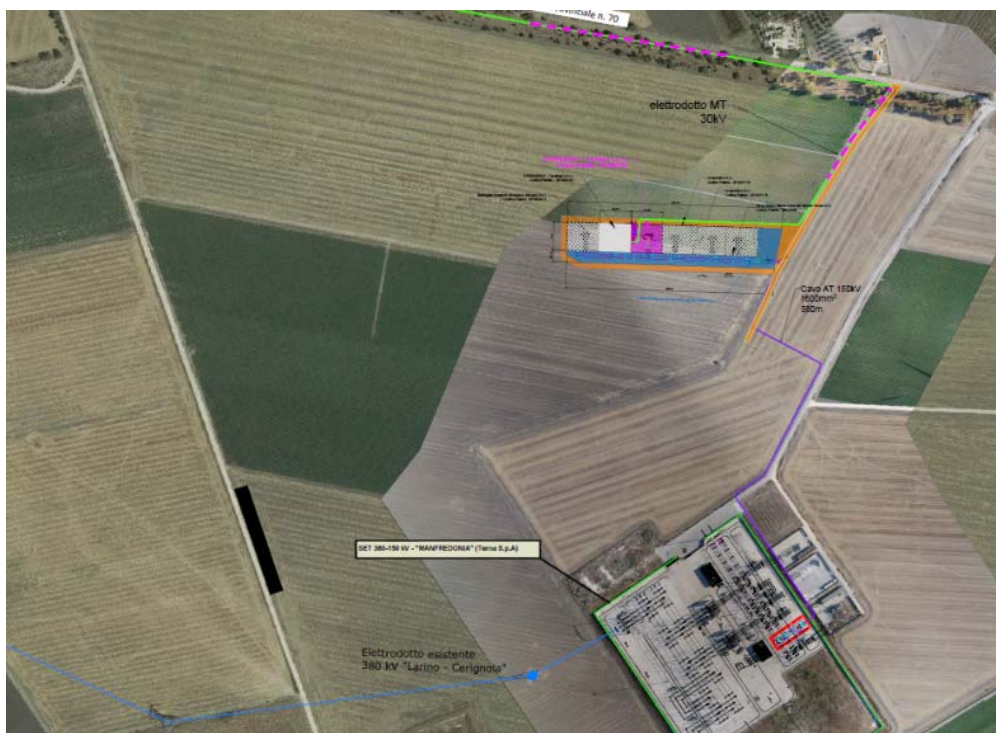
Fig. 2. Inquadramento su ortofoto opere di Rete: in verde, l’elettrodorsale MT 30kV; in arancio, la viabilità di accesso; in Magenta, la SSE Produttore; in viola, l’elettrodorsale AT 150kV; riquadrata in rosso, la posizione dello Stallo 150kV assegnato.
