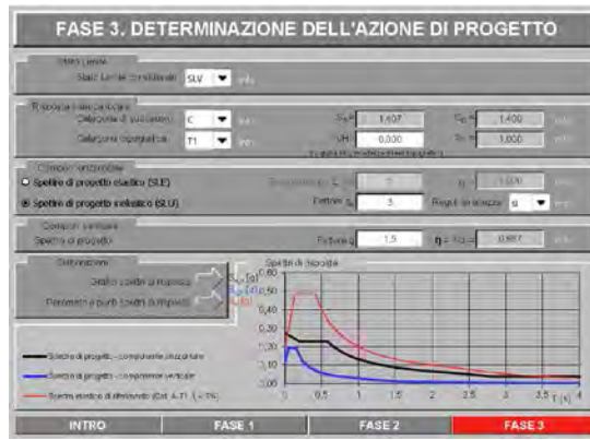
Spettri di risposta (componenti orizz. e vert.) per lo stato limite: SLV
