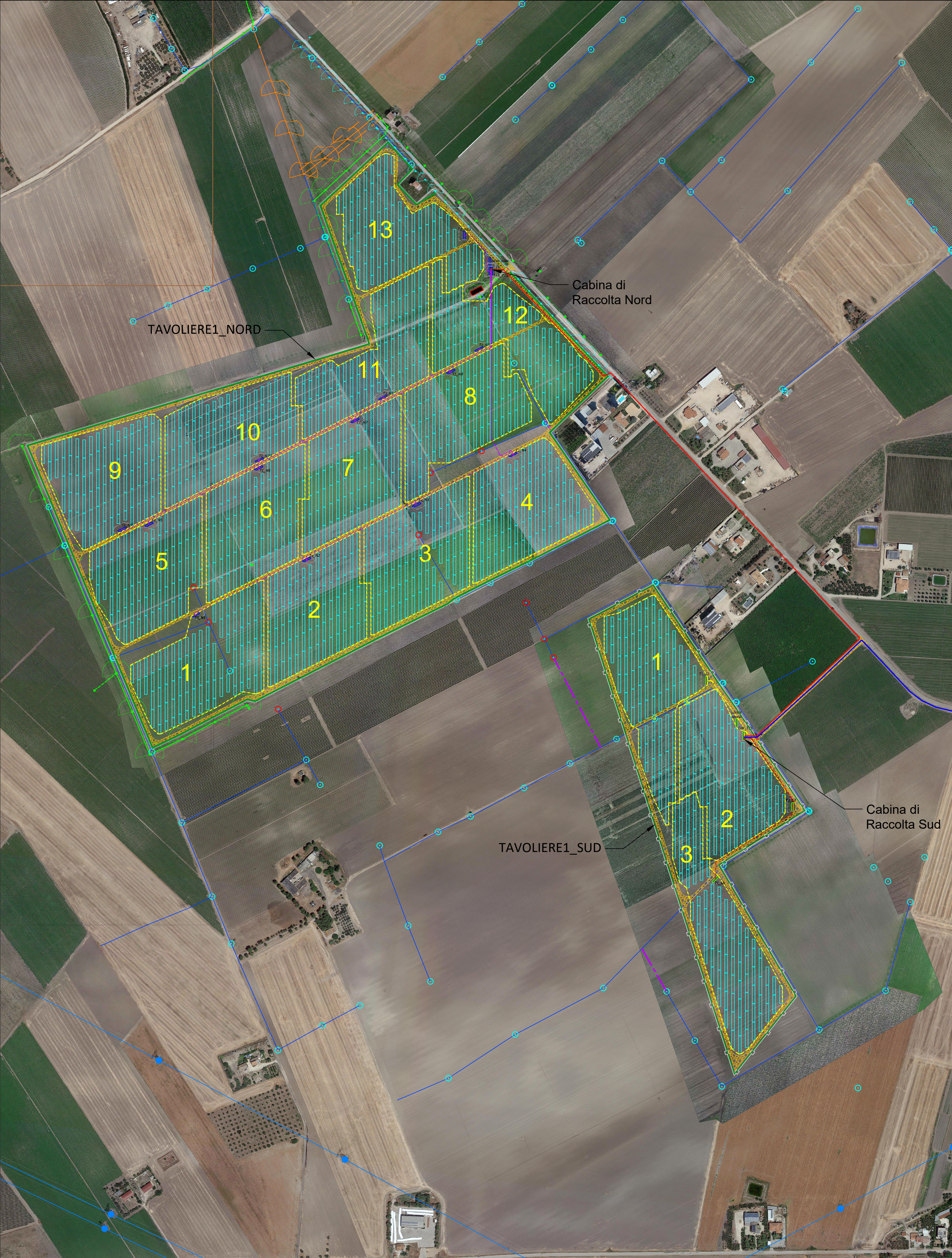
PLANIMETRIA SU ORTOFOTO - AREA GENERATORE FOTOVOLTAICO - SCALA 1:4.000
