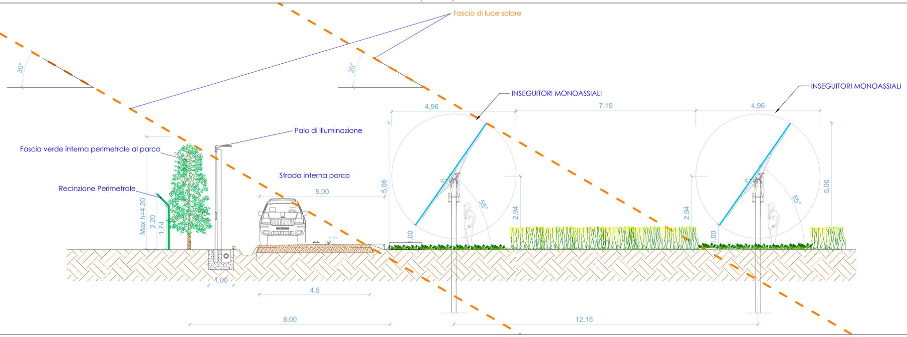
**POSIZIONAMENTO INSEGUITORI CON UN FASCIO DI LUCE SOLARE AVENTE UN ANGOLAZIONE PARI A 15°**
