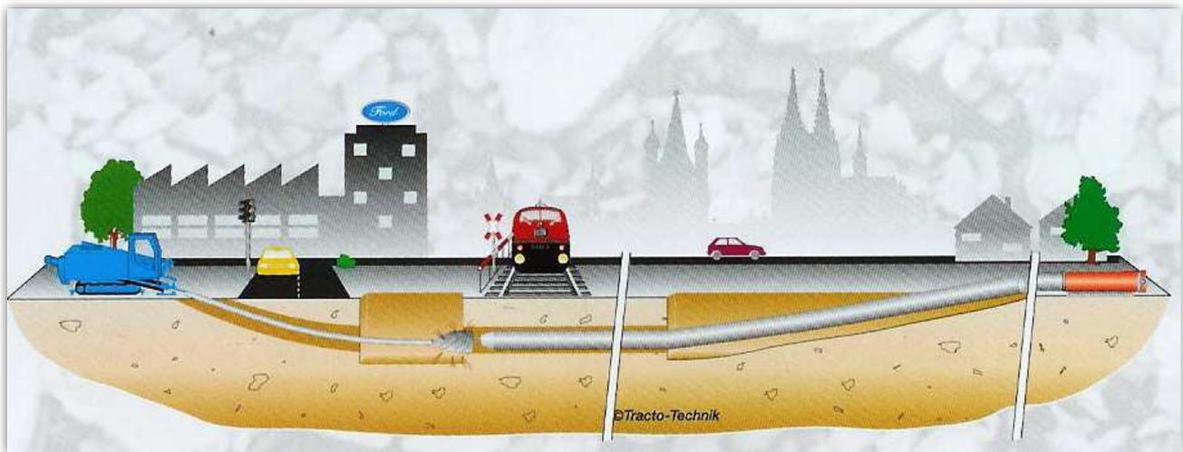
Fig. 9. Schema di principio dell’attraversamento in T.O.C.
