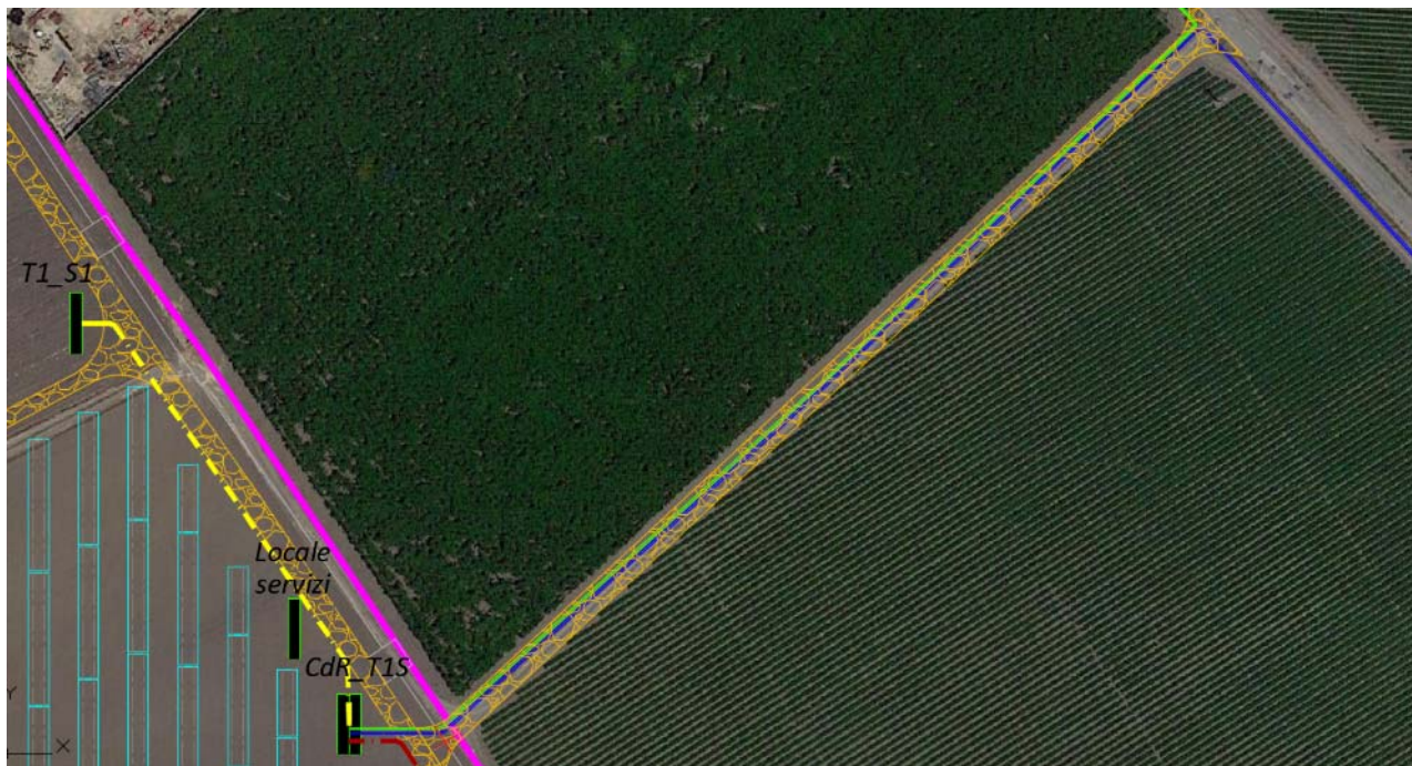
Fig. 8. Dettaglio della posizione della CdR SUD: in giallo, la linea proveniente dal subcampo T1_S1; in rosso la linea proveniente dalla cabina T2_S2; in verde la dorsale proveniente dalla CdR NORD; in blu le linee dorsali in partenza verso la Sottostazione Produttore
