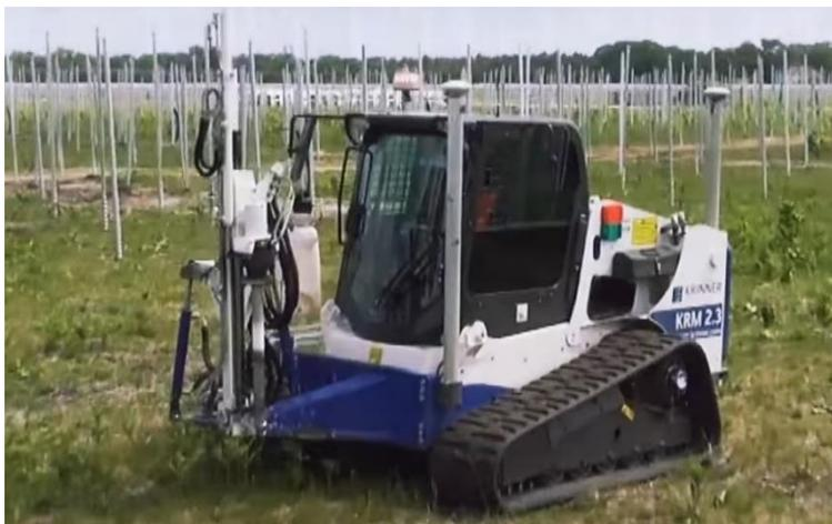
Figura 17. Esempio di fissaggio delle strutture di supporto
