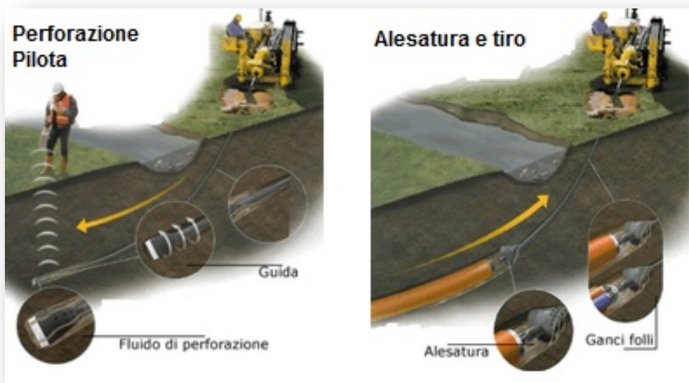
Figura 31 - tecnologia di trivellazione orizzontale controllata (TOC)
