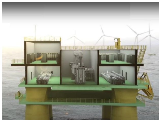
Figura 2: Esempio di OSS semisommersibile a pianta quadrata
