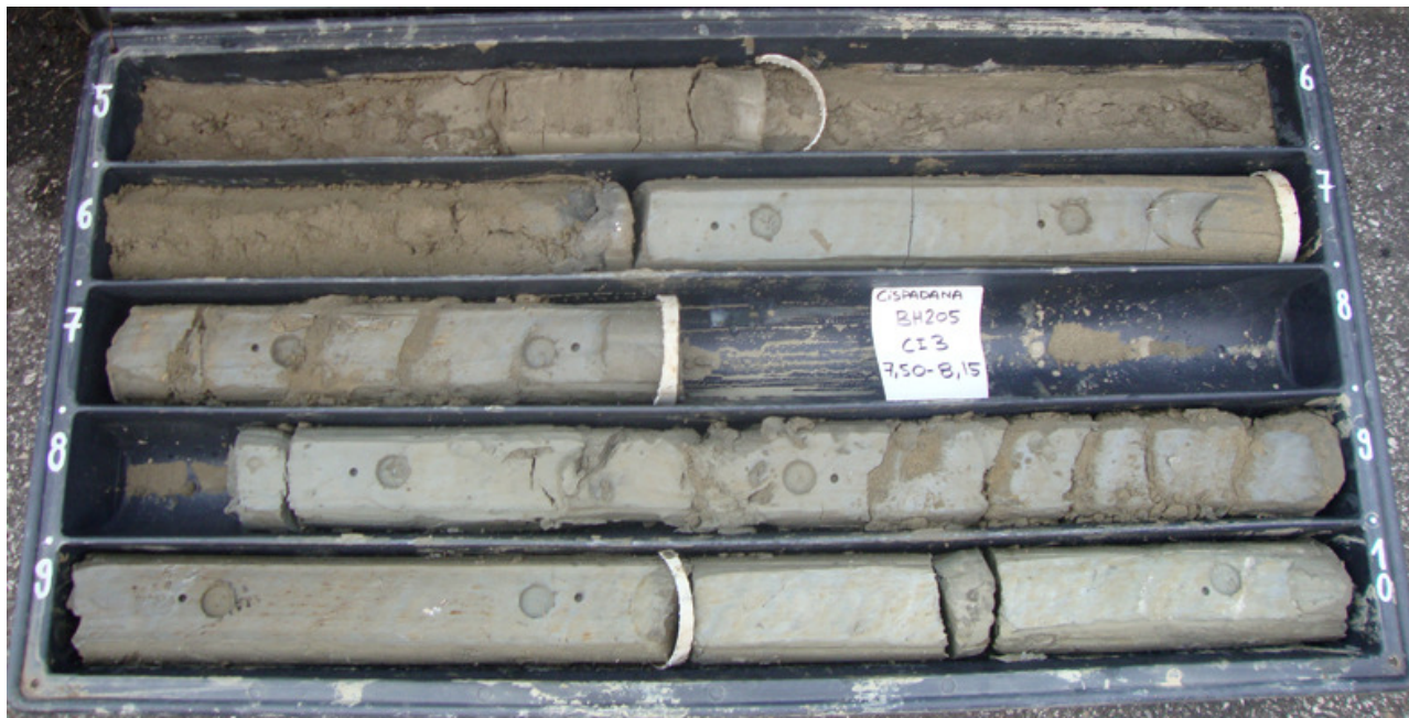
Sondaggio BH 205 da m -5 a m -10
