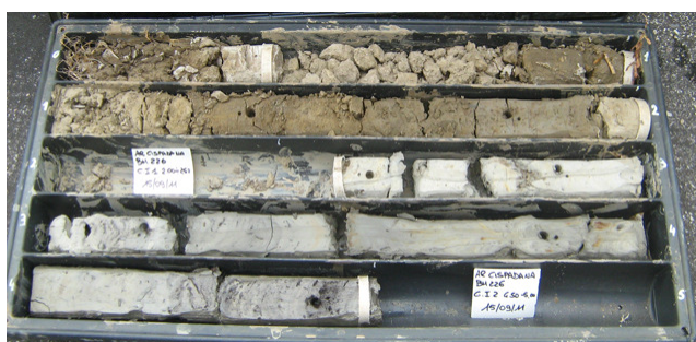
Sondaggio BH 226 da m 0 a m -5
