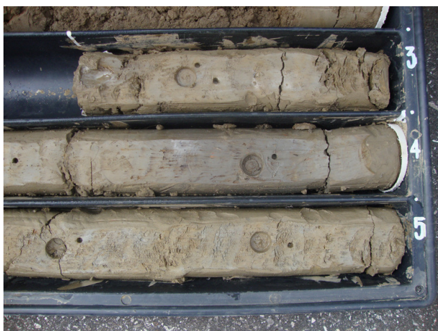
Sondaggio BH 203 particolare impaludamento a -3,80m ca.
