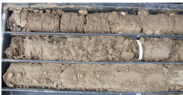
Sondaggio BH 204 particolare dei frustuli nel primo 1,5m.
