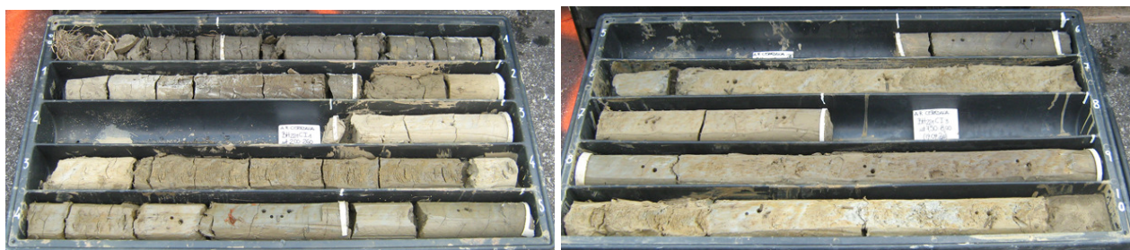
Sondaggio BH 221 da m 0 a -5m
