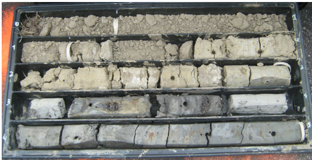
Sondaggio BH 227 da m 0 a m -5
