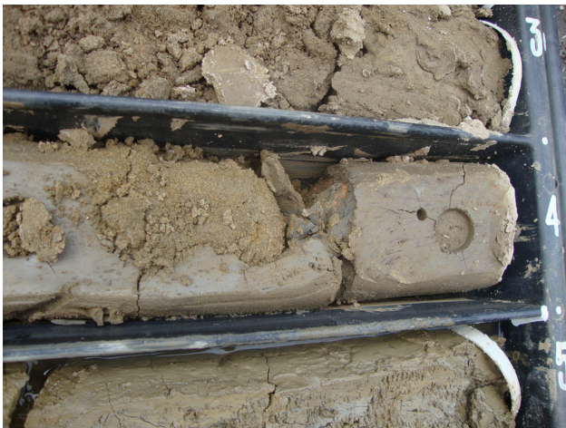
Sondaggio BH 202 particolare impaludamento a -3,80m ca.
