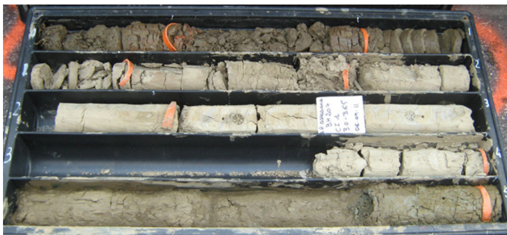
Sondaggio BH 207 da m 0 a -5m
