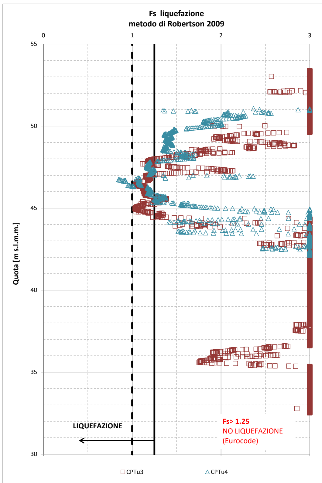
Figura 6.5.3 - Fattore di Sicurezza nei confronti del rischio di liquefazione (per terreni indagati con CPTu, in funzione della quota assoluta)
