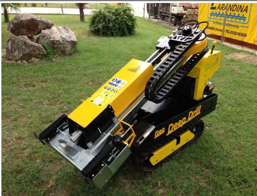
La resistenza opposta dal terreno alla punta conica viene correlata alle caratteristiche fisico-meccaniche e portanti del terreno, consentendo inoltre di riconoscere, con buona approssimazione, la stratigrafia del sottosuolo; il tutto fino alla profondità a cui la resistenza del terreno è tale da non permetterne più l'infissione (rigetto della punta).
