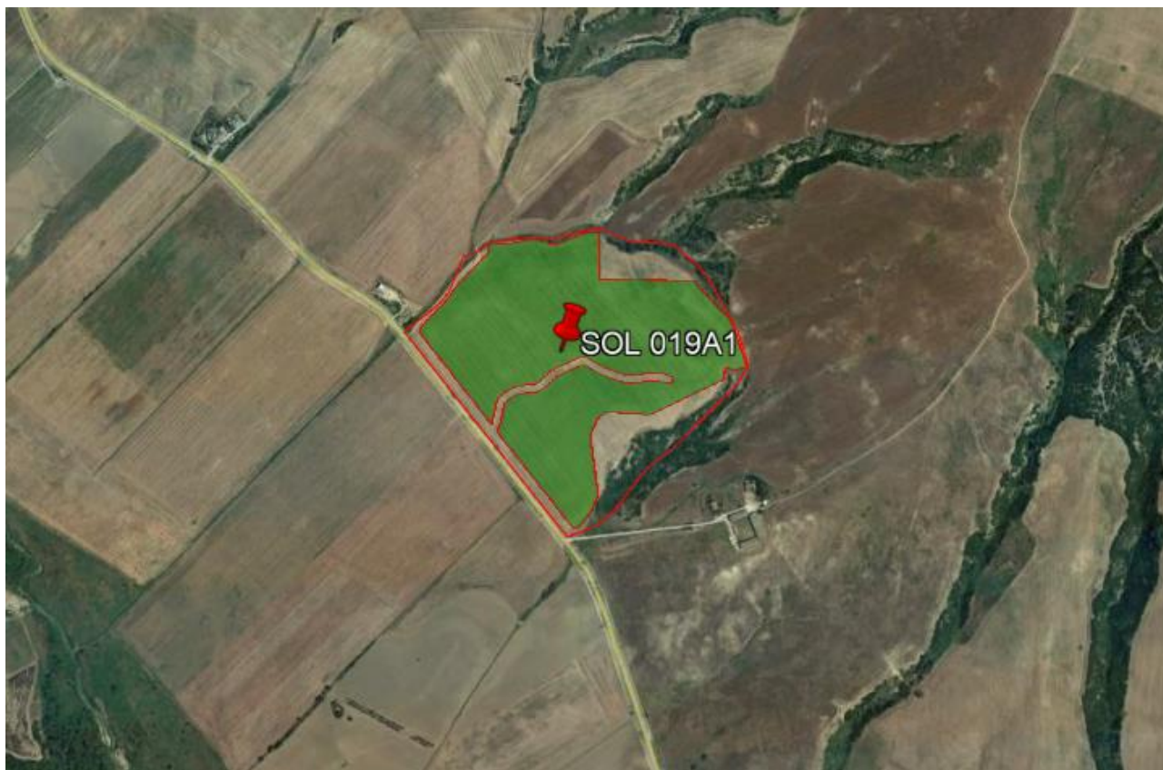
Figura 2-1. Ortofoto con disposizione planimetrica dell'impianto fotovoltaico in progetto (foto aerea Google Earth).
