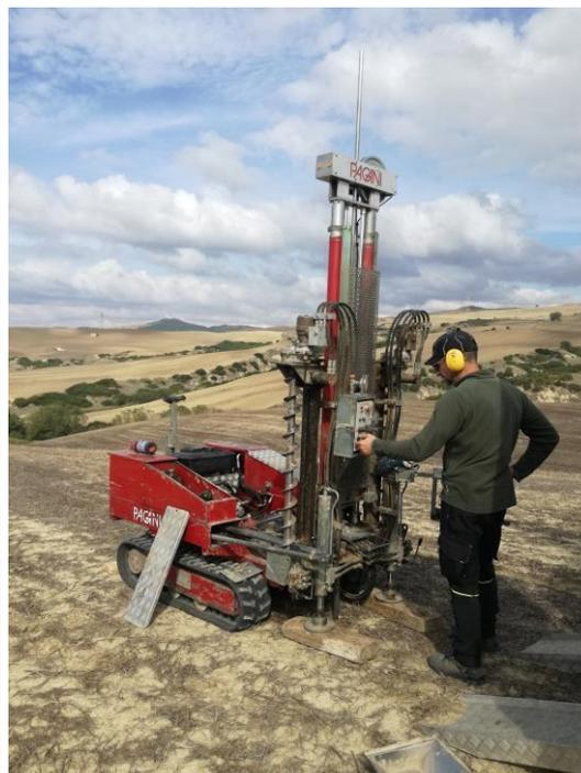
Foto 3 - 4: Prova penetrometrica DPSH 2
