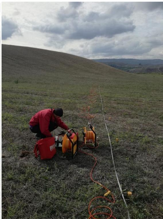
Foto 7 - 8: Indagine sismica di tipo MASW
