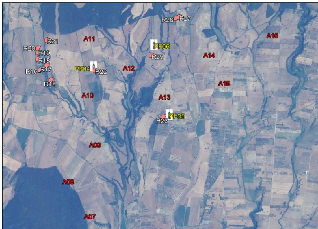
Figura 3: Inquadramento dell'area di progetto con evidenza delle turbine di progetto (AXX - in rosso), dei recettori sensibili o fabbricati individuati (poligoni rosa "RXX") e delle postazioni fonometriche indicate con la dicitura "PFX".
