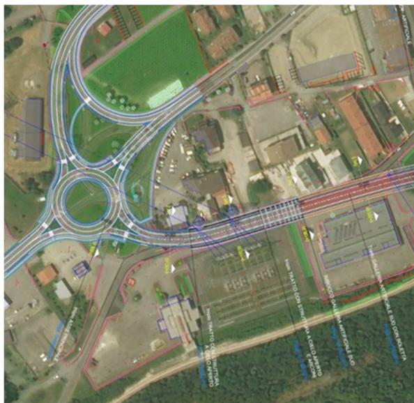
**Figura 4-1 Schema planimetrico Rotatoria Sud del Progetto precedentemente redatto**
