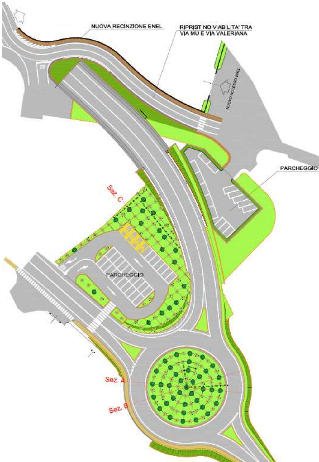
Figura 6 Imbocco Sud – Zona da inerbire in adiacenza al nuovo parcheggio
