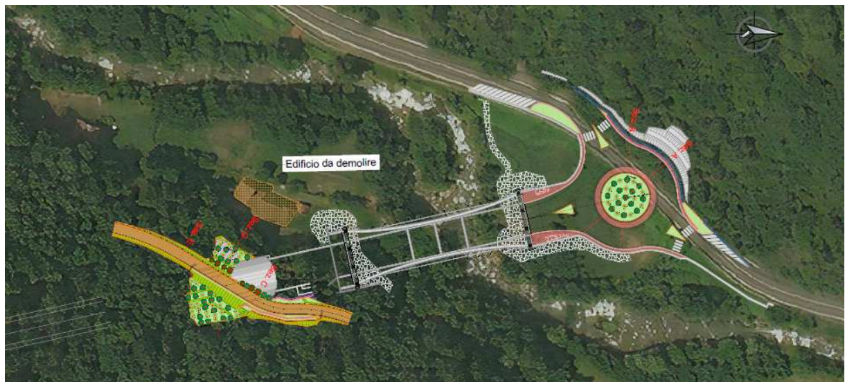
Figura 8 Imbocco Nord – Planimetria degli interventi di mitigazione ambientale
