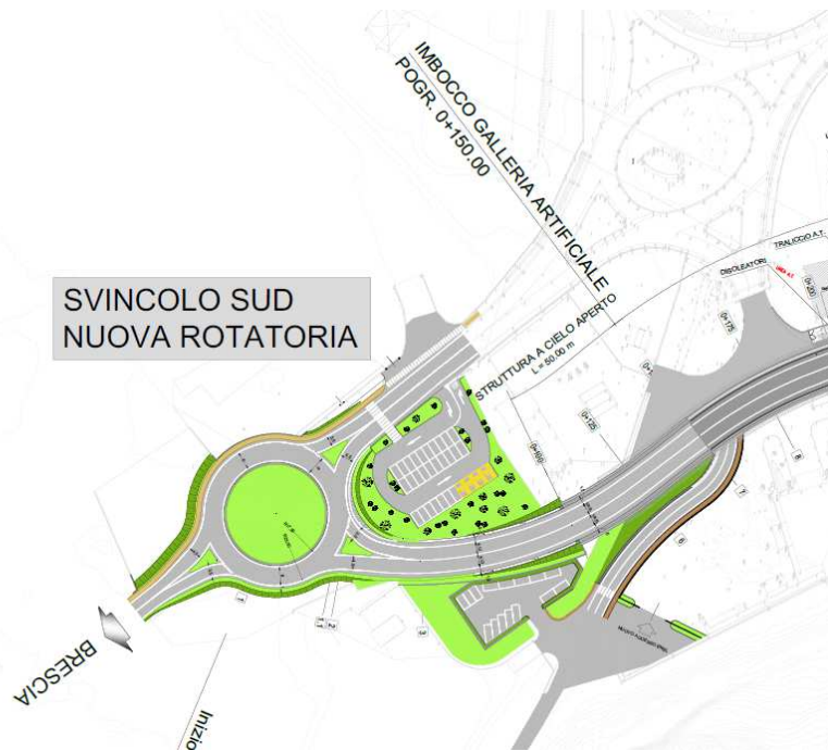
Figura 3 – Schema planimetrico Rotatoria Sud -
