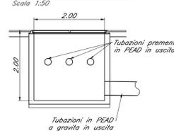
**Pianta pozzetto di sconnessione 2x2**
