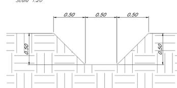
**Sezione pozzetto di sconnessione 2x2**
