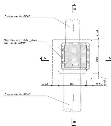
**Sezione pozzetto A-A**
