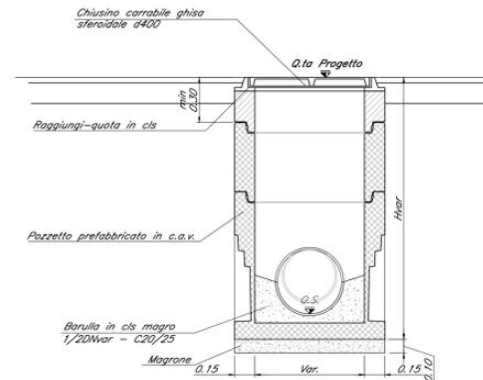
**Sezione pozzetto B-B**
