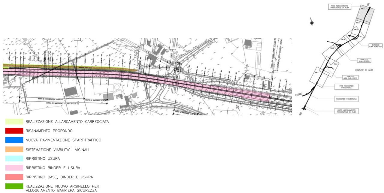
Figura 8: Planimetria di progetto – Tavola 7 Fine adeguamento Tangenziale di Alba (Fonte: Allegati alla Lista di controllo)
