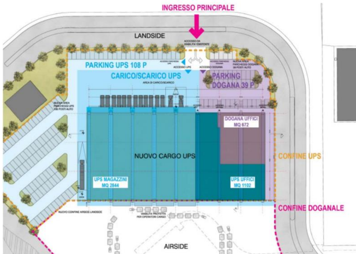
Figura 3-10 Riprotezione UPS e Dogana (codice 2.19) - Studio di progetto, planimetria
