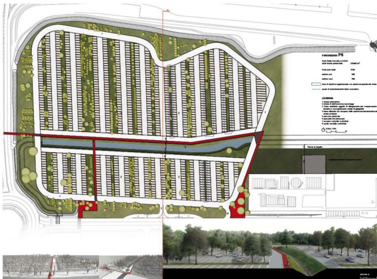
Figura 3-18 Nuovo parcheggio "P6" - Planimetria e render (i tratti in rosso indicano i percorsi pedonali principali)
