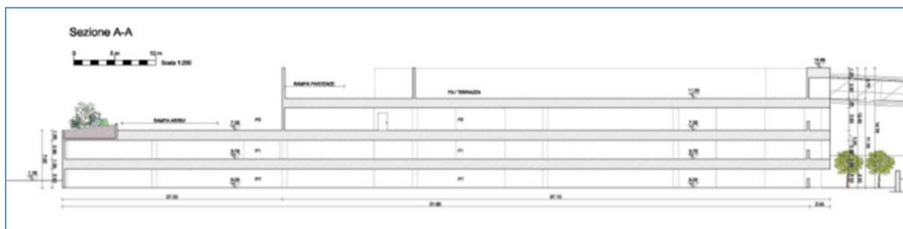
Figura 3-16 Sezione trasversale del parcheggio multipiano
