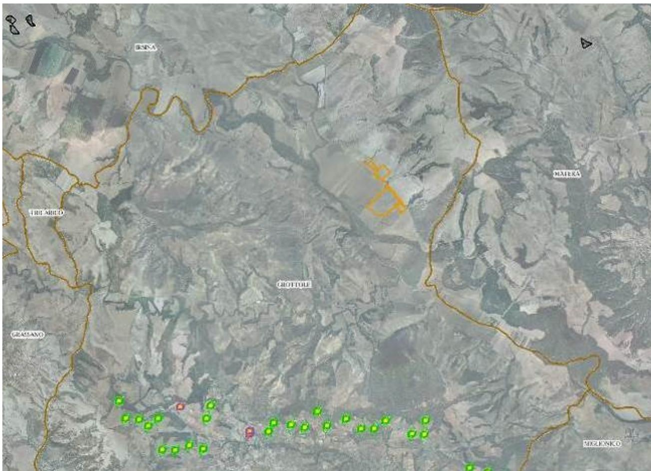
**Fig. 18:** *Impatto cumulativo degli impianti da fonti di energia rinnovabile. In arancio l'impianto di progetto, in verde e giallo i rotori eolici di grande diametro, in arancio e viola il minieolico e in nero gli impianti fotovoltaici in esercizio.*
