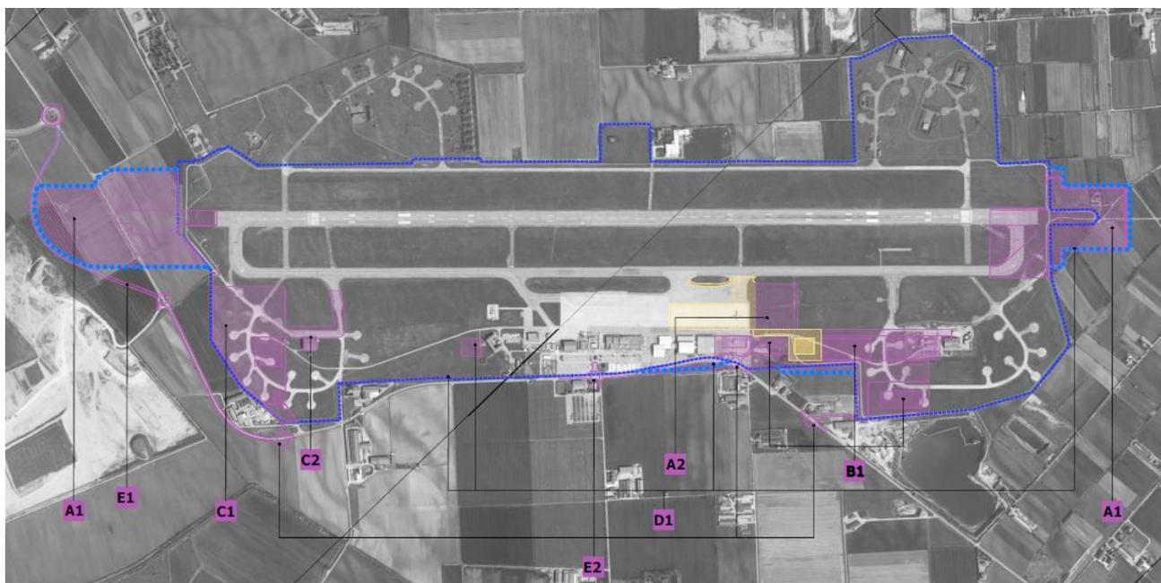
Figura 2 – immagini estratte dal progetto preliminare che illustrano le tre distinte fasi di realizzazione del progetto. La fase 3 in particolare indica in particolar modo le aree sulle quali sono previste opere di scavo.
