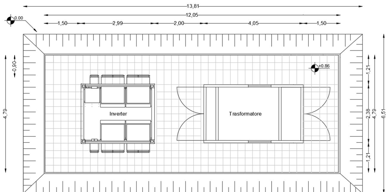
In particolare, per quanto riguarda le cabine inverter, la soluzione adottata risulta ancora più sostenibile, in quanto le stesse sono costituite da container metallici prefabbricati.
