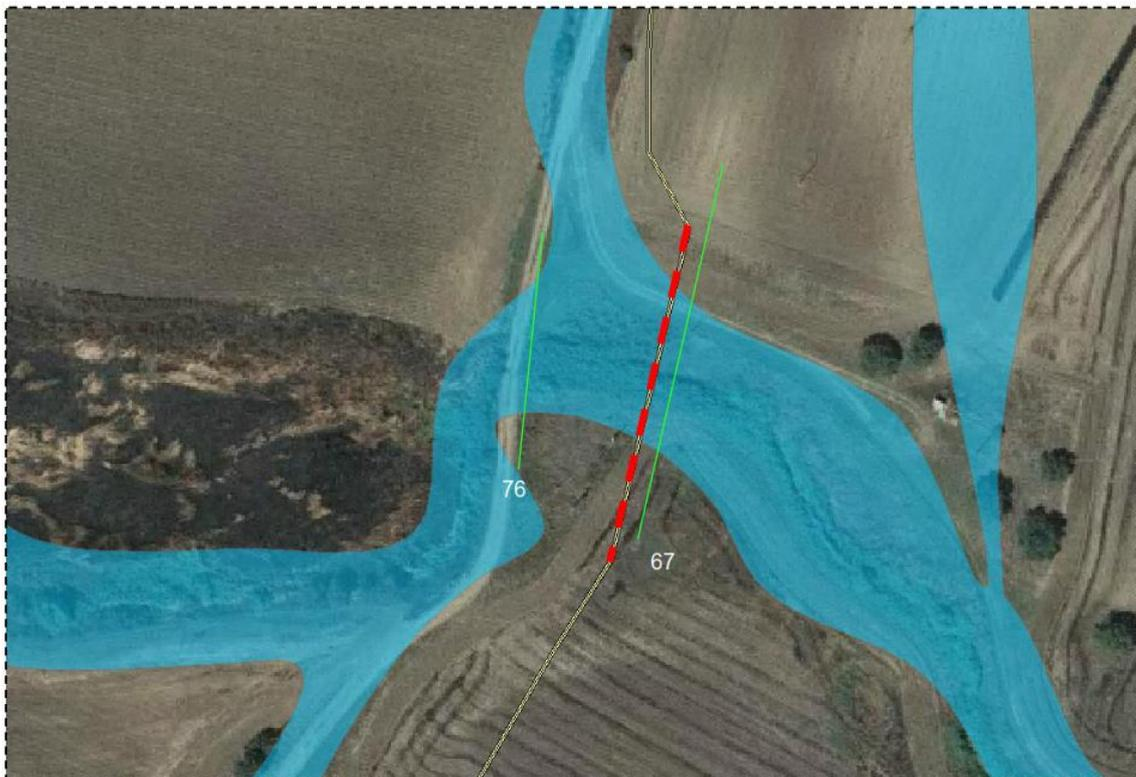
Fig. 47 Area "E Centro". Particolare del tratto di cavidotto a realizzarsi con tecnica T.O.C
