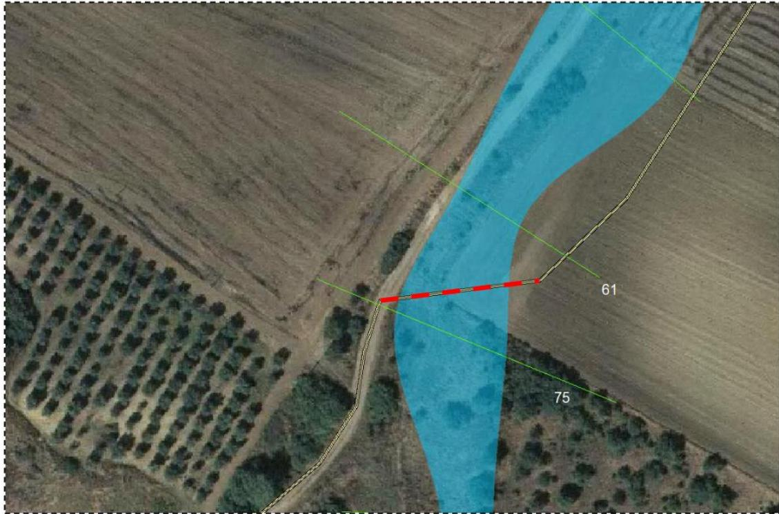
Fig. 49 Area "E Sud". Particolare del tratto di cavidotto a realizzarsi con tecnica T.O.C
