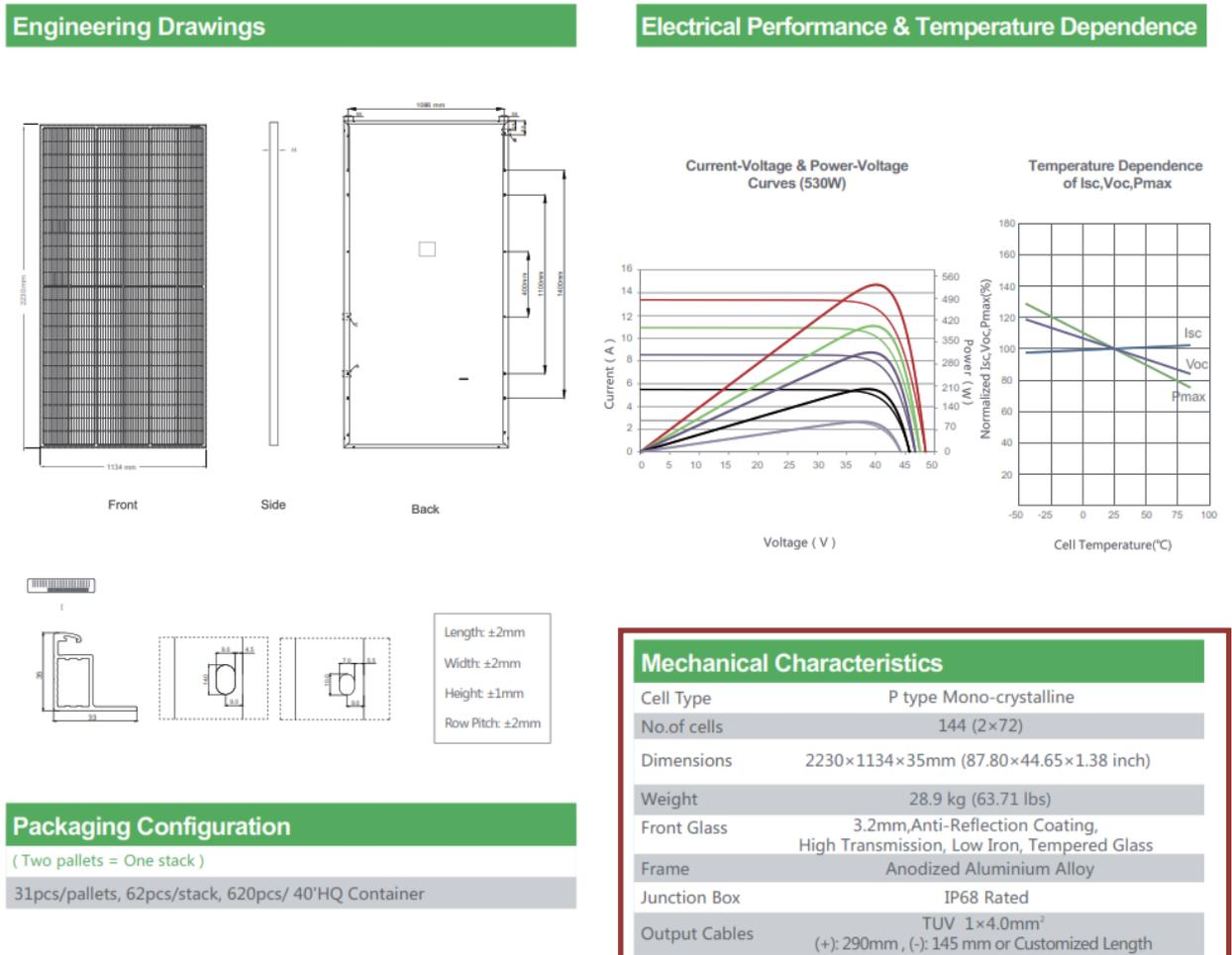
Fig. 14 Data Sheet Modulo Fotovoltaico \_1
