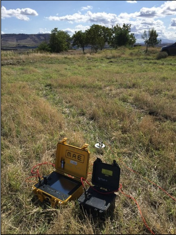
Figura 14 - Foto della realizzazione della prova di rumore ambientale HVSR.
