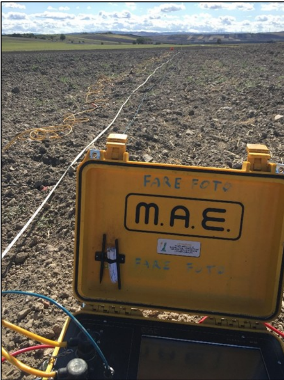
Figura 12 – Foto dello stendimento della prova geofisica MASW1.
