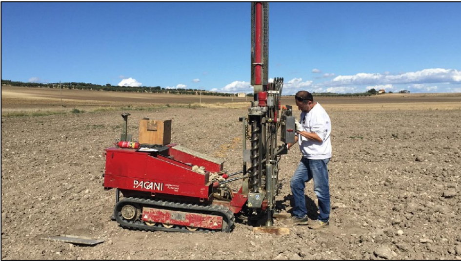
Figura 9 – Foto dell’esecuzione delle prove penetrometriche DPSH1 (in alto), DPSH2 (al centro) e DPSH3 (in basso).
