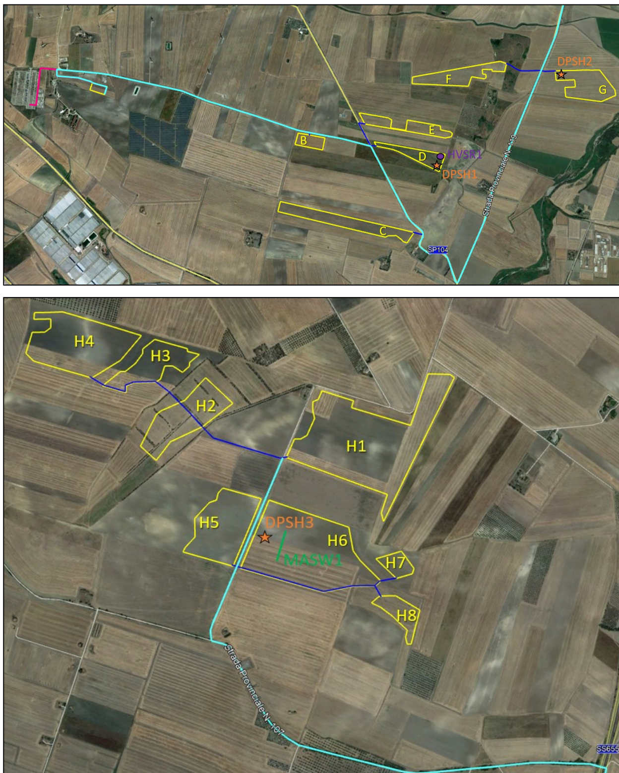
Figura 10 - Ubicazione delle indagini geotecniche (DPSH1, DPSH2 e DPSH3) e geofisiche (MASW1 e HVSRI) eseguite nei vari lotti di terreno.
