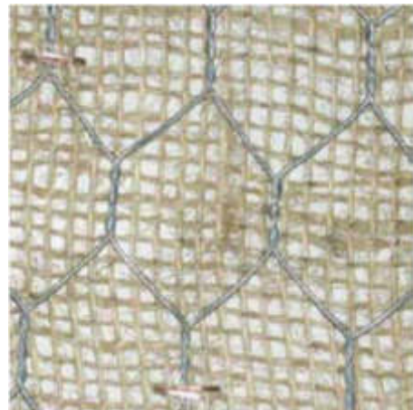
Geocomposito in rete metallica a doppia torsione preaccoppiato meccanicamente con biorete in cocco da 700 g/m 2 , biodegradabile al 100%.
