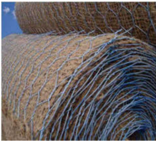
Geocomposito in rete metallica a doppia torsione preaccoppiato meccanicamente con biorete in cocco da 700 g/m 2 , biodegradabile al 100%.
