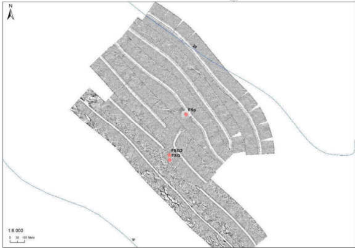
Fig. 47- Mosaico SSS Fiume Santo. (FSp: intra-matte piccola; FSG e FSG2: intra-matte grande)
