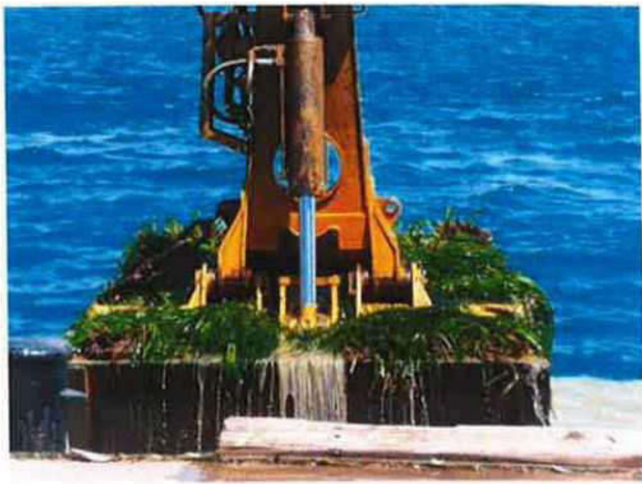
Figura 27 – Benna bivalve idraulica (da relazione Bedini 2014)
