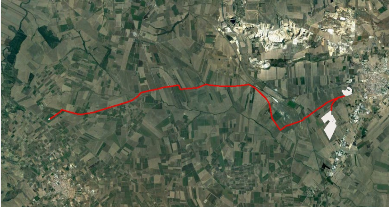
Figura 3 - Percorso dell'elettrodotto interrato MT da realizzare
