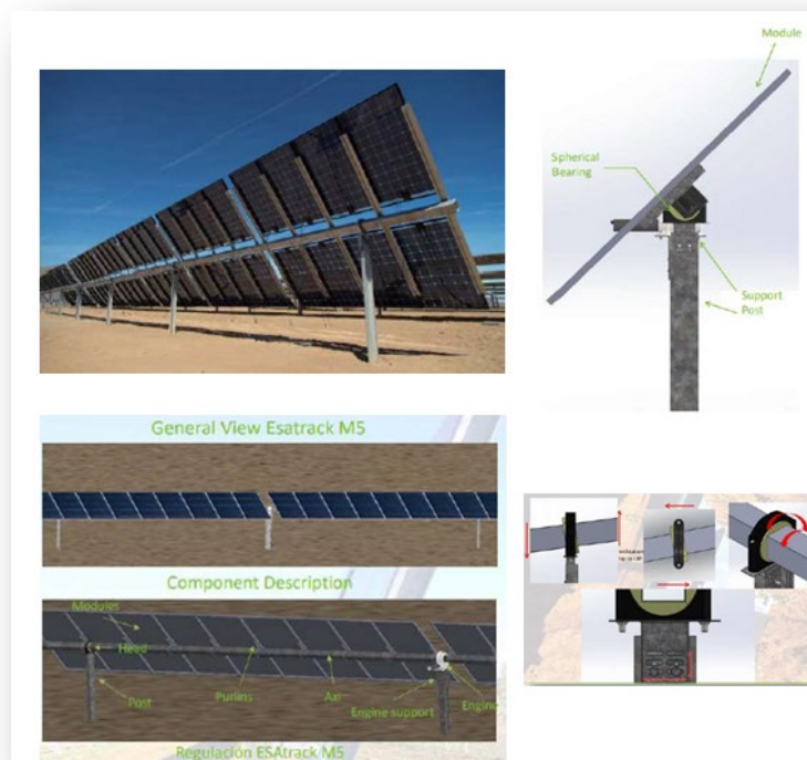
Figura 8 - Strutture di sostegno e sistema di inseguimento solare
