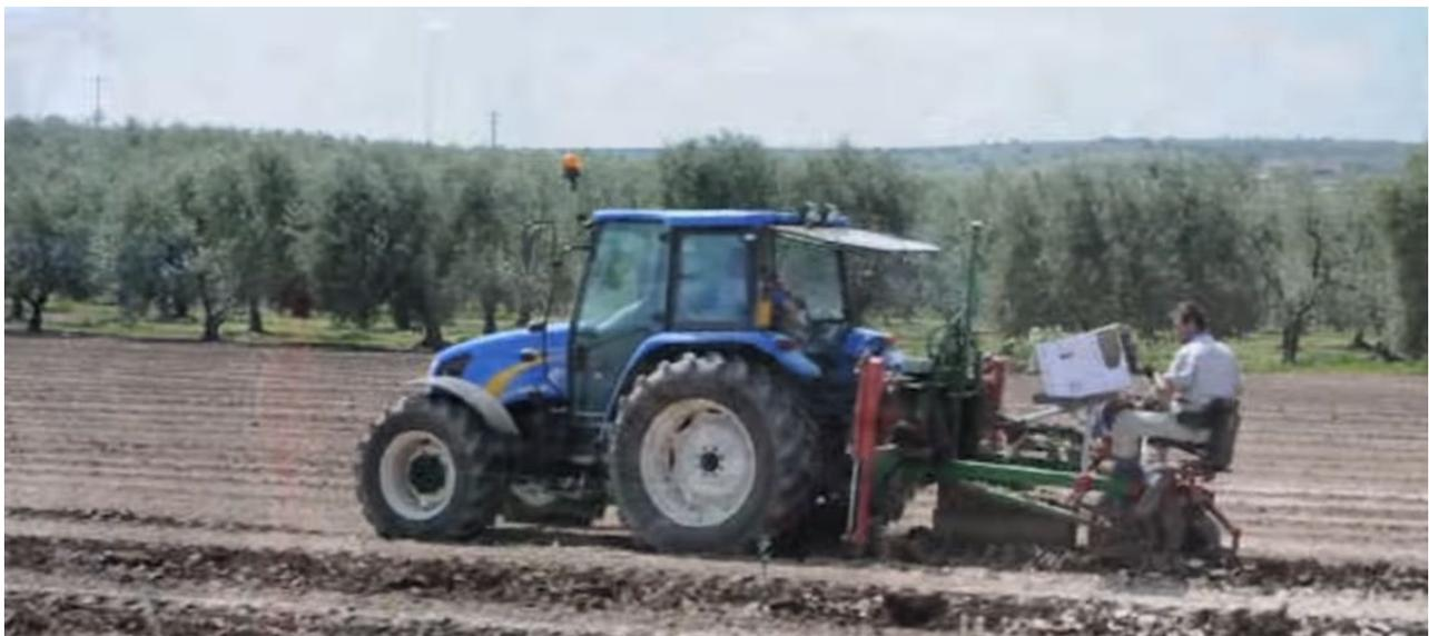
*Figura 2. Piantumazione meccanica del superintensivo*
