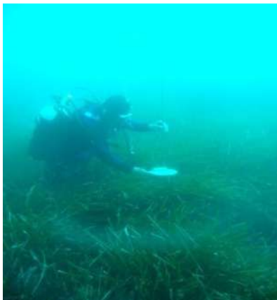
Figura 17: rilievi dello spessore della matte col penetrometro.
