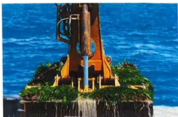
Figura 2 – Benna bivalve idraulica (da relazione Bedini 2014)
