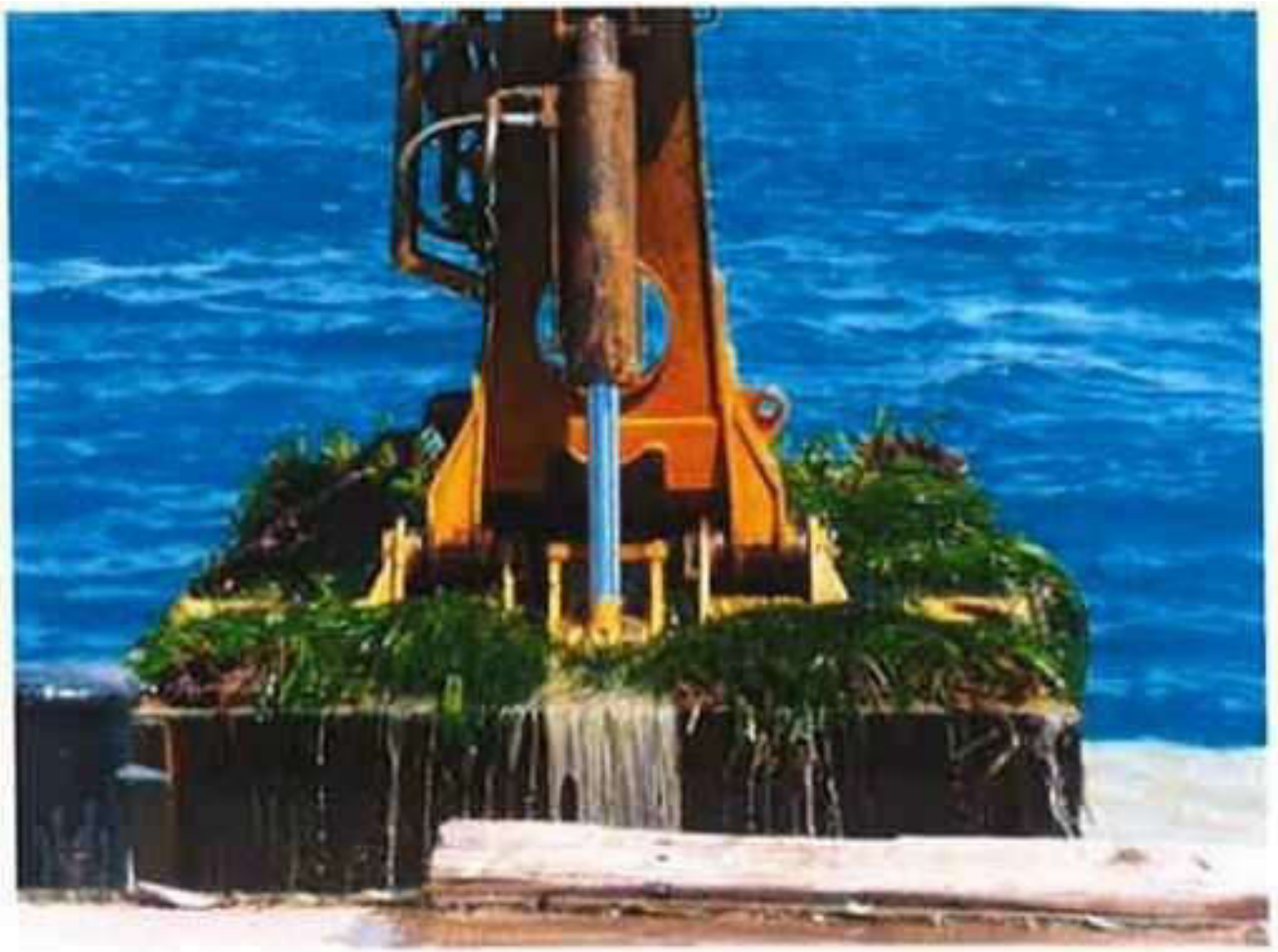
Figura 27 – Benna bivalve idraulica (da relazione Bedini 2014)
