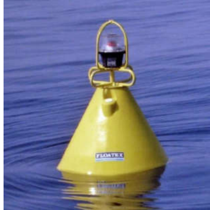
Figura 3 - Boa luminosa di posizionamento
