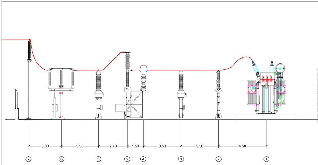
PIANTA E SEZIONE BB' - TRASFORMATORE
