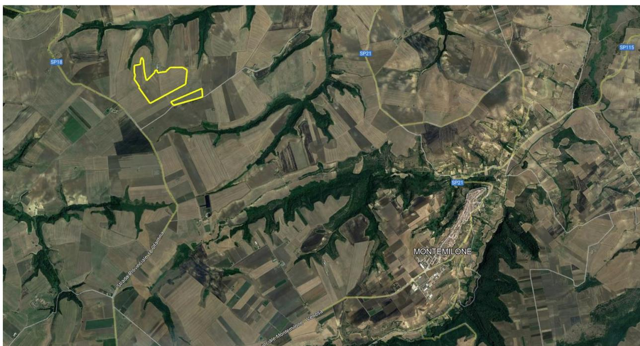
Tale progetto prevede l'installazione di **29.354** moduli fotovoltaici da 655 Wp che produrranno complessivamente una potenza pari a **19.226,87 kW**.
