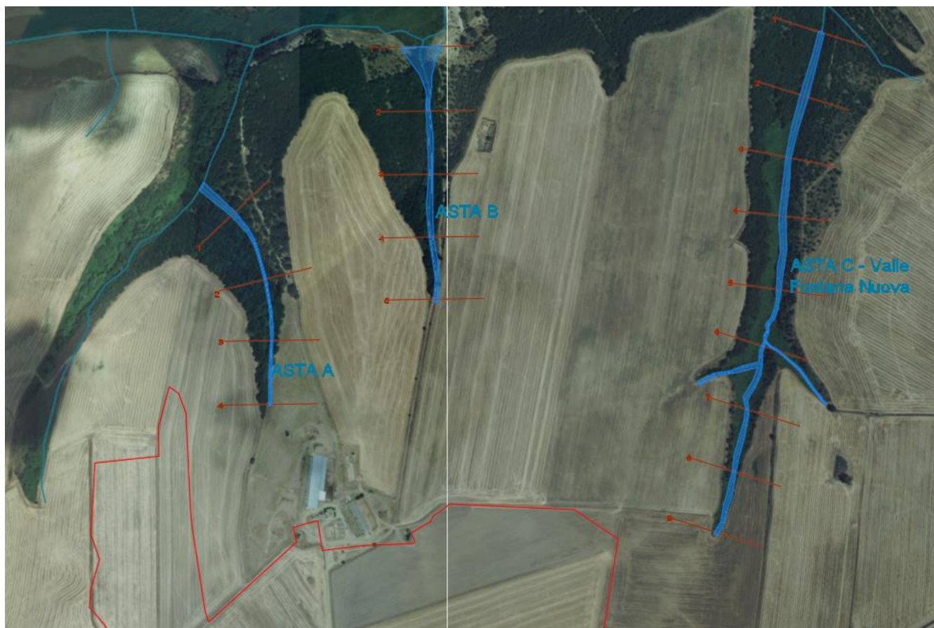
Figura 12 – Planimetria con indicazione delle aree inondabili duecentennali.
