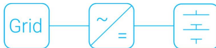
Schema semplificato di un convertitore monostadio
