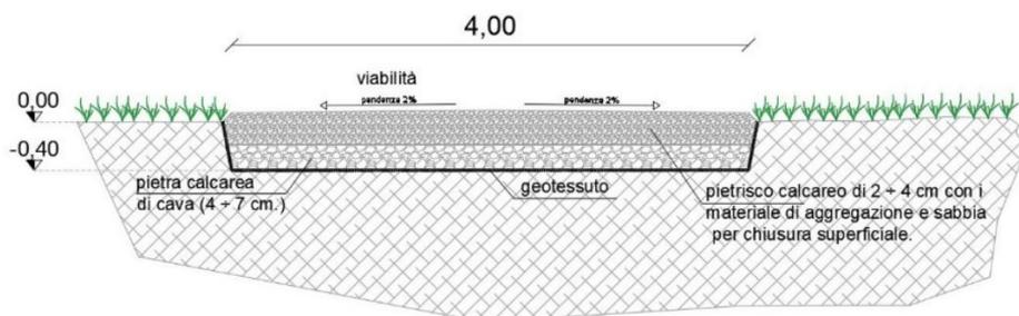
Al fine di garantire una maggiore durabilità dell'opera stradale ed evitare ristagni d'acqua, in corrispondenza del piano di sottopavimento verrà steso uno strato drenante di geotessile non tessuto agugliato in poliestere.
