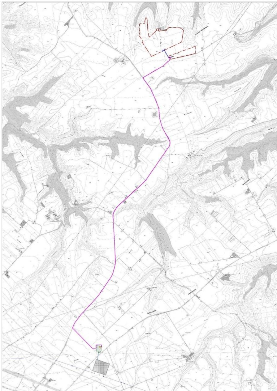
Il percorso cavidotto prevede l'interramento di due terne di cavi MT per una lunghezza complessiva di **7055 metri**. La scelta del percorso e il suo posizionamento è stato condizionato anche da una attenta ricognizione sul campo sullo stato di fatto della principale viabilità esistente che conduce al punto di consegna.
