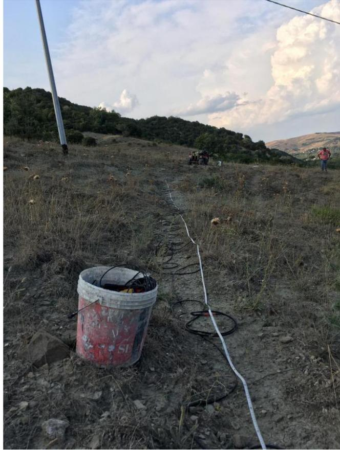
*Dall'interpretazione delle prove penetrometriche, in funzione dei numero dei colpi si è potuta riscontrare la sequenza stratigrafica fino alla profondità di circa 8 metri senza intercettare il Bedrock.*
