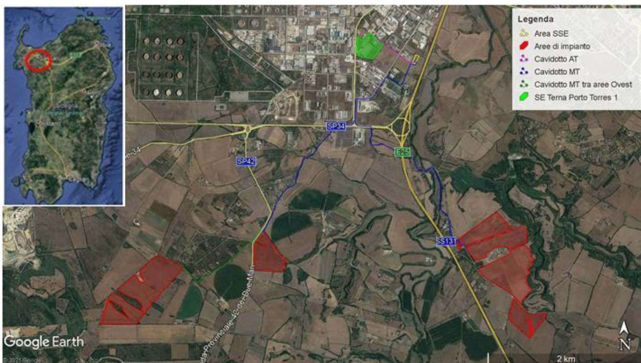
Inquadramento generale su Ortofoto In rosso sono indicate le aree recintate all'interno delle quali saranno installati i pannelli fotovoltaici.
