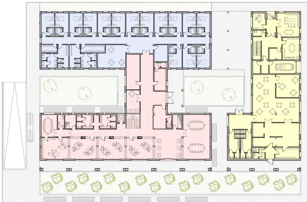
**Figura 2.5-9 pianta piano terra caserma di polizia**
