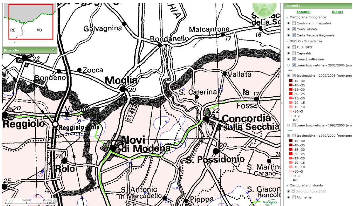
FIGURA 6.2-3. CARTOGRAFIA DELLE VELOCITÀ DI MOVIMENTO VERTICALE DEL SUOLO (PORTALE CARTOGRAFICO DI ARPA EMILIA-ROMAGNA) TRA REGGIOLO E CONCORDIA SULLA SECCHIA, SI PUÒ OSSERVARE CHE NEGLI ANNI 2002-2006 I VALORI DI SUBSIDENZA SONO RISULTATI DELL'ORDINE DI 0÷5 MM/ANNO E DIMINUITI RISPETTO AL PERIODO 1992-2000 CON AMPIE AREE A SUBSIDENZA NULLA
