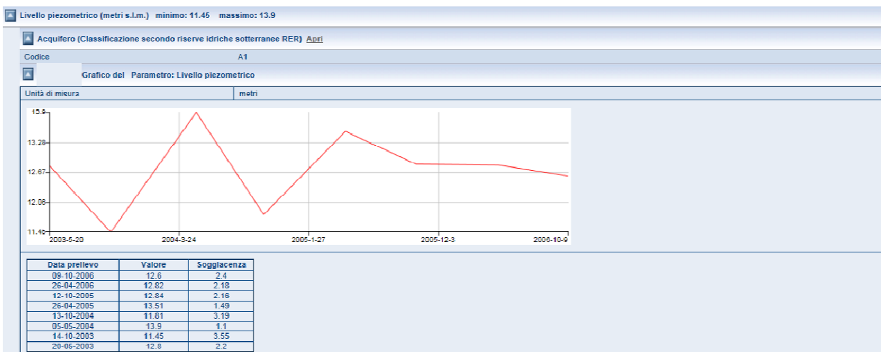
FIGURA 10.2-20. LIVELLI DI FALDA (ACQUIFERO A1) MISURATI NEL POZZO ARPA MO03-01 UBICATO A SUD DELL'ABITATO DI MIRANDOLA
