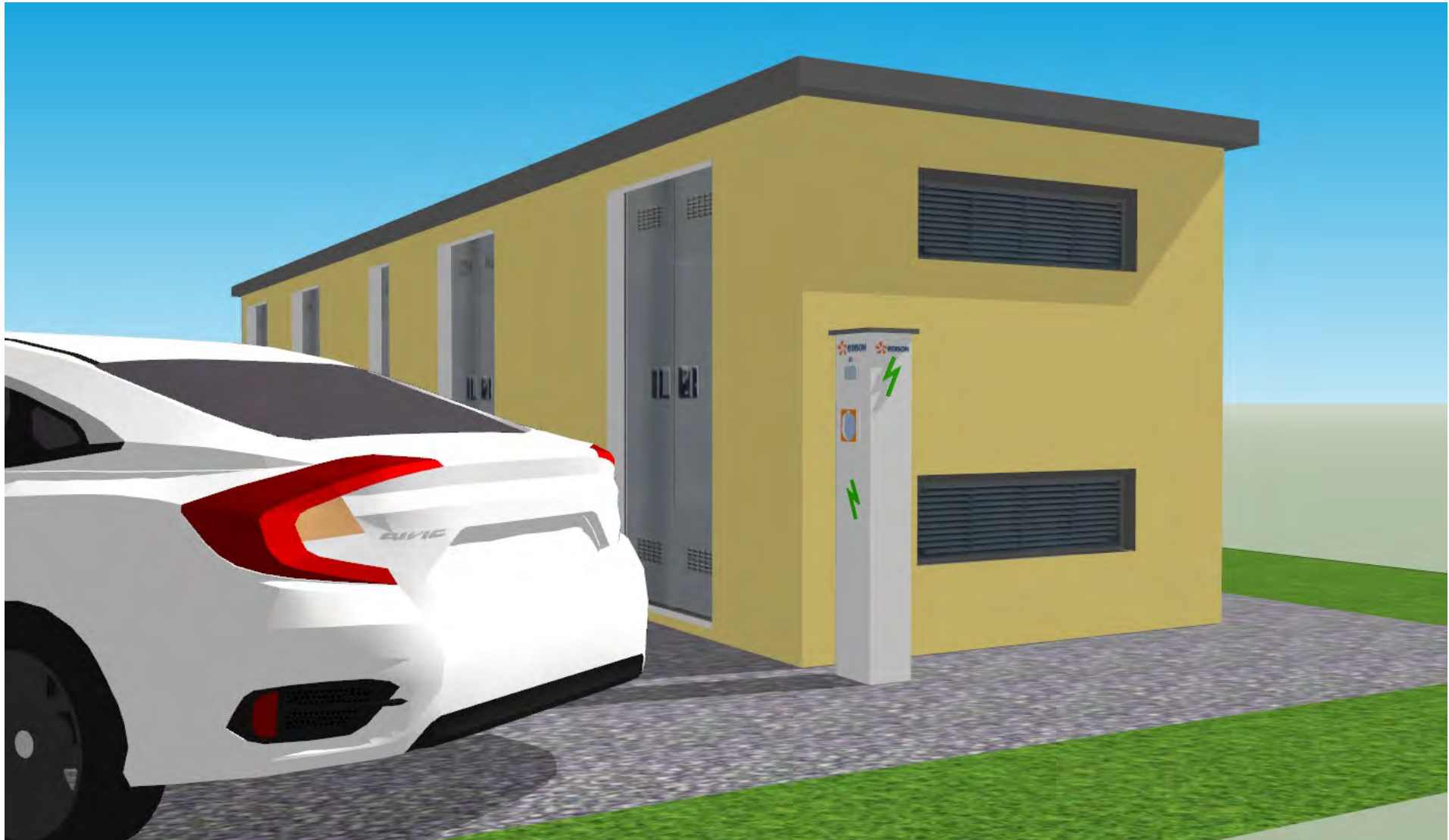
Situazione in progetto 8 vista di dettaglio della cabina di connessione elettrica con possibilità di installazione colonnina di ricarica auto.
