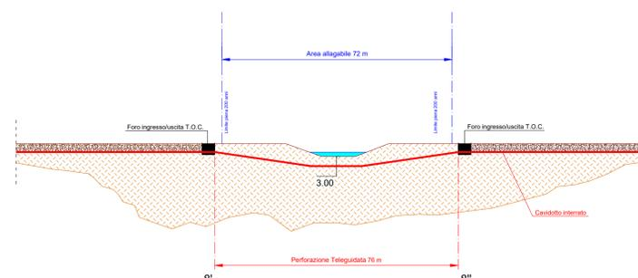
N.B.: La perforazione telegrafata sarà raccordata a destra al cavidotto interno, in zona allagabile, ma su strada esistente, entro 500 metri dalla banchina alla strada mediante scavo semplice e successivo ripristino dello stato dei luoghi, in modo tale da non modificare l'assetto idrogeologico attuale.
