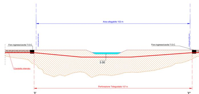
N.B.: La perforazione telegrafata sarà ricordata a sinistra al cavidotto interno, in zona allagabile, tuttavia esso sarà posto in banchina alla strada esistente, mediante scavo semplice e successivo adattamento della strada, in modo tale da non modificare l'assetto idrogeomorfologico del sito.
