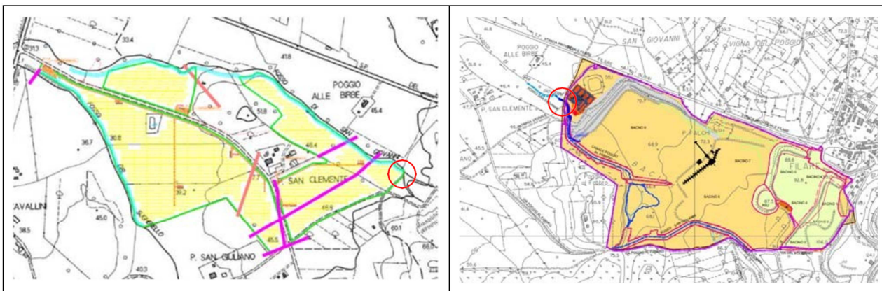
Figura 3.1 – A sinistra i limiti dell'area di realizzazione dell'impianto fotovoltaico ed a destra quelli del progetto di bonifica dei Bacini di San Giovanni. Il tratto in adiacenza tra i due progetti è cerchiato in rosso.
