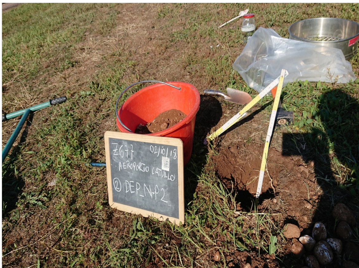
FOTO 1: individuazione punto prelievo ed eliminazione primi 10 cm di suolo (top soil)
