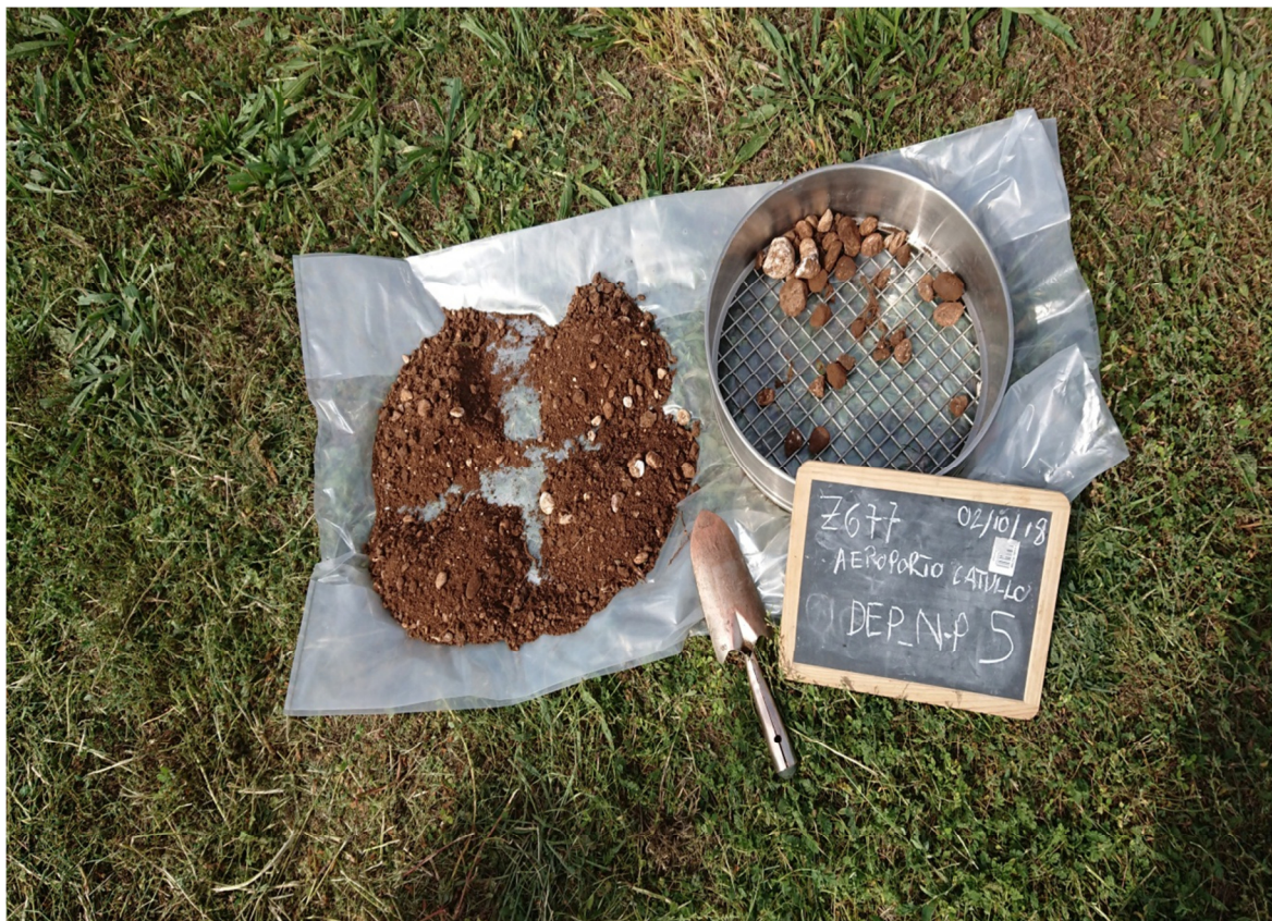
FOTO 2: preparazione campione mediante miscelamento su telo degli incrementi e setacciatura a 2 cm, riduzione volumetrica per quartatura e preparazione aliquote
