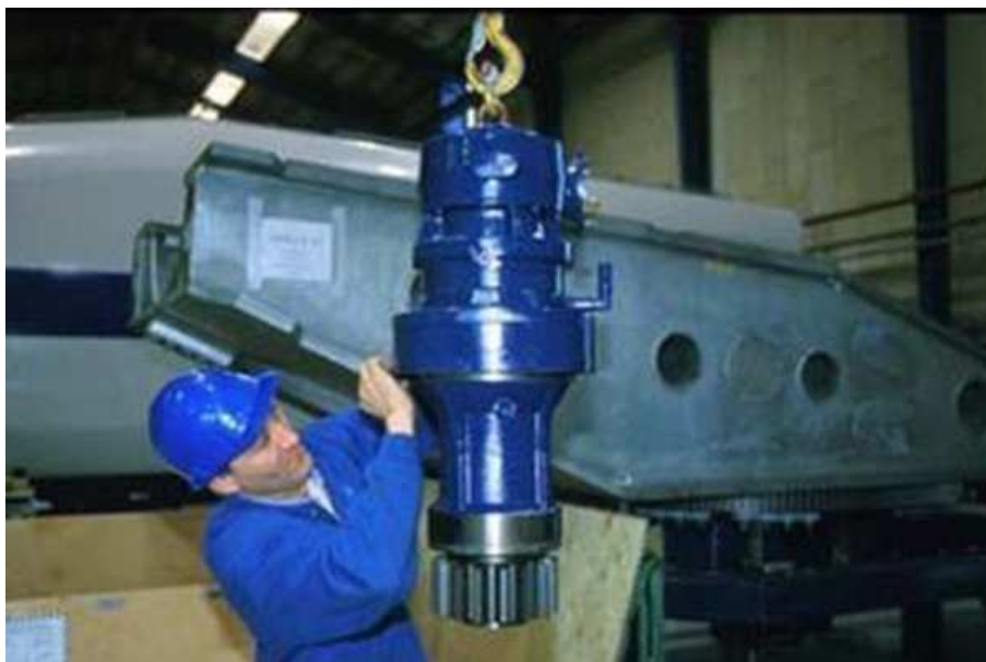
Figura 8: Motori di giro e riduttori
