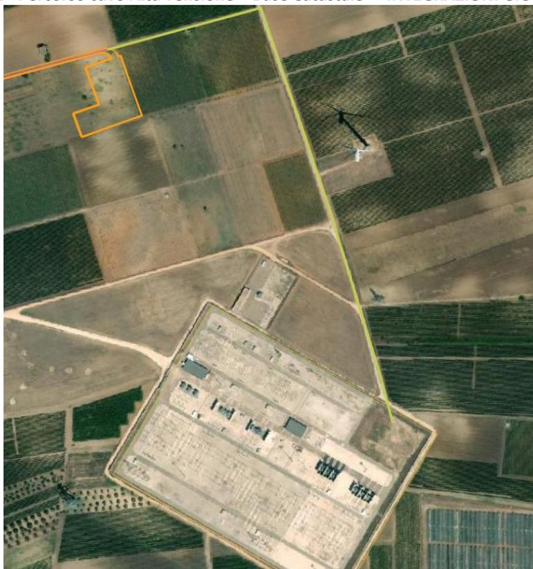
**Figura 22 - Percorso cavo Alta Tensione – Base Ortofoto - PROGETTO DEPOSITATO**
